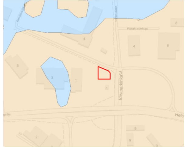
Kuva: Ote maaperäkartasta, vaiheittaisen asemakaavan muutosten sijoittumisalue merkitty punaisella. Oranssi väri kuvastaa hiekkamoreenia.
