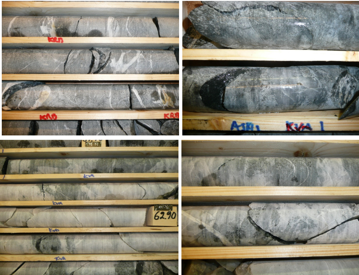
Kuva 11. Aitolahden kairausnäytteitä; 1) Nuoria breksioivia karbonaatti-kvartsijuonia; 2) sinertäviä, vanhempia kvartsijuonia, 3-4) nuorempia kvartsijuonia, joita karbonaattijuonet leikkaavat
